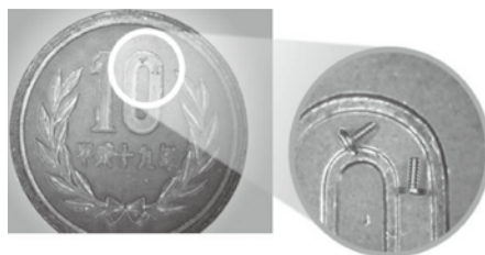
世界最小(直径0.3mm)の転造ねじ (大新工業製作所の転造平ダイスで転造)
