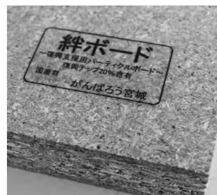
津波で倒されたクロマツを使った「絆ボード」
