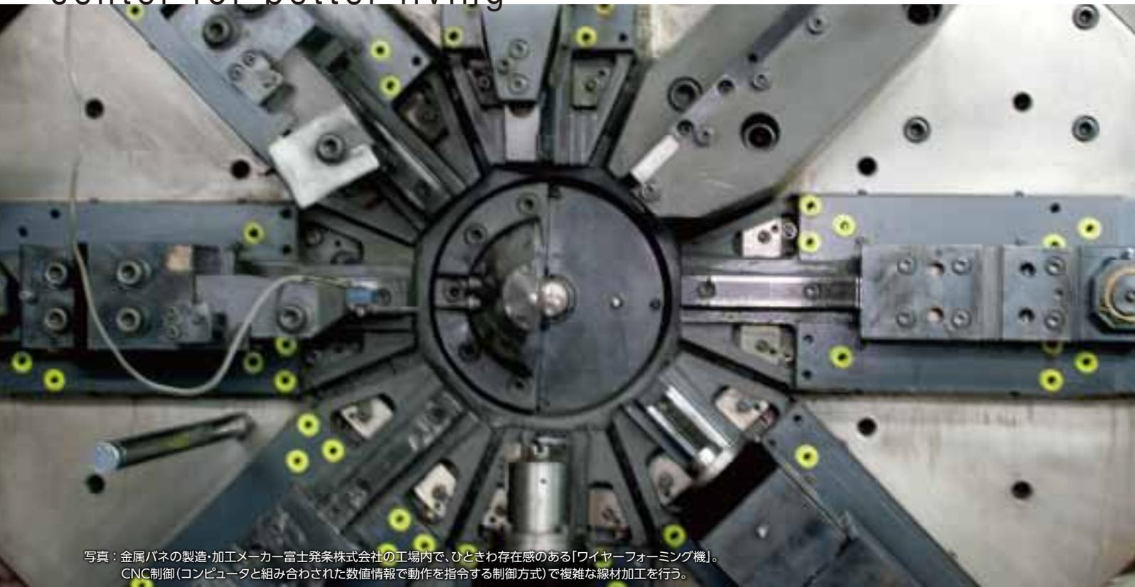
写真：金属パネの製造・加工メーカー富士発条株式会社の工場内で、ひときわ存在感のある「ワイヤーフォーミング機」。
